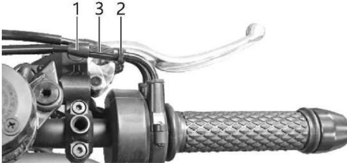
El puño del acelerador sirve para controlar las revoluciones del motor.
