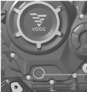
· La comprobación del nivel y el llenado de aceite se realizan en el cárter por el lado izquierdo de la motocicleta, como se muestra en la figura.
