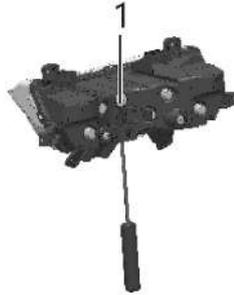
Ajuste el amortiguador trasero para adaptarse a diferentes cargas de sobre la motocicleta y estados de la carretera. La precarga del muelle es ajustable.
