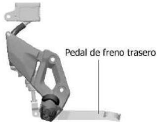
Pise el pedal de freno trasero, la rueda trasera se frenará y se iluminará la luz de freno del piloto trasero.
