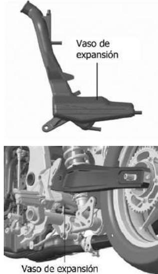
El refrigerante elimina el calor de los componentes del motor, manteniéndolo en su temperatura normal de funcionamiento.
