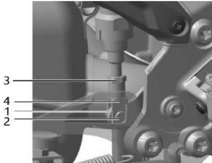
Mantenga la altura del pedal del freno trasero en una posición adecuada. En caso de que se encuentre demasiado alto, es fácil que lo pise durante la conducción, lo que provoca que las pastillas y el disco de freno se toquen y causen daños o desgaste por la fricción.
