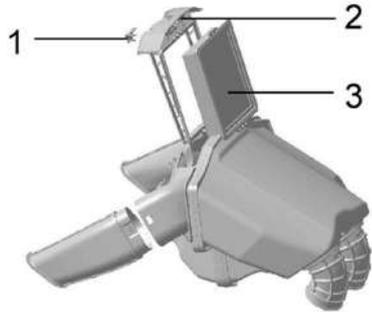
1. Bloqueo de fijación del elemento filtrante
