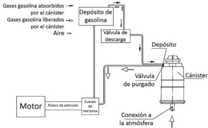
El diagrama muestra las conexiones del sistema de control de evaporación del combustible
