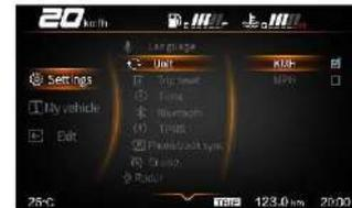
CONFIRMAR para entrar. Pulse ARRIBA o ABAJO para ajustar el valor y luego pulse CONFIRMAR para volver a la parte superior. Cuando finalice el ajuste, pulse VOLVER para regresar al segundo menú.
