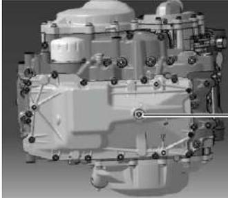
En caso de que el nivel de aceite sea demasiado alto, retire el tornillo de drenaje de aceite motor (1) con una llave de vaso como se muestra en la figura. Descargue un poco de aceite y luego vuelva a apretar el tornillo de drenaje del aceite motor (1). Un nivel de aceite demasiado bajo o alto puede dañar el motor. Asegúrese de que el nivel de aceite sea el correcto.
