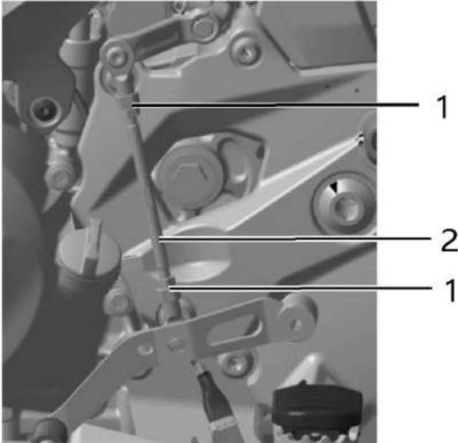
El estado de la carretera cambia durante la conducción. La palanca del cambio de velocidades puede afectar a la velocidad de conducción y fuerza de tracción. La varilla del reenvío de la palanca de cambio de velocidades se ajusta para adaptarse a sus hábitos de conducción.
